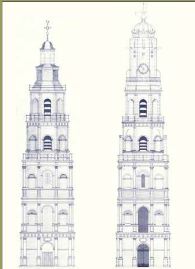
Links de internationaal beroemde 'Pasqualinitoren' vóór de kerkbrand van 1911 en rechts de toren na de restauratie van 1923. Restauratietekeningen uit 1982 door architectenbureau ir. T. van Hoogevest.
